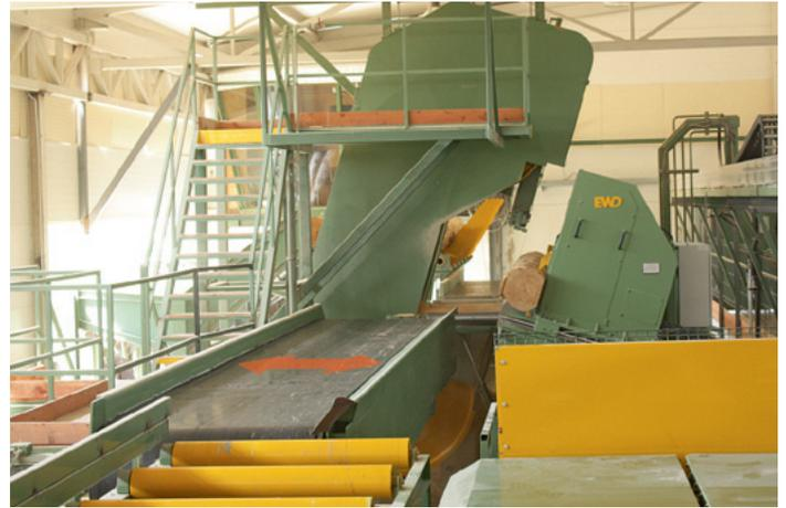
**Für das Ausschleusen der Schwarten** lässt das Förderband hinter der Bandsäge seitlich verschieben, die Schwarten fallen in die Entsorgung
