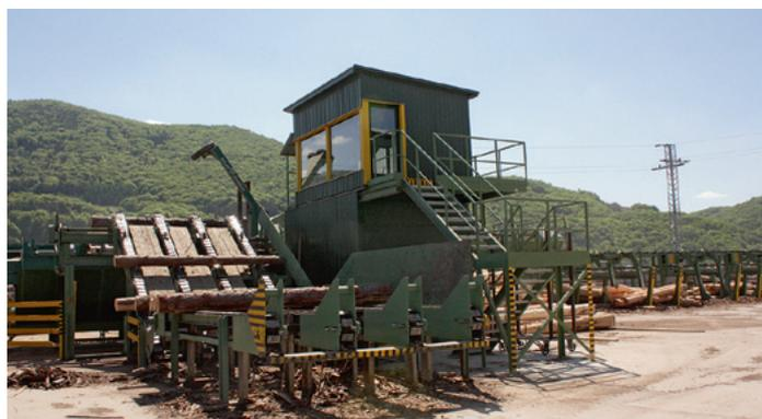
Rundholzplatz wurde als erster Schritt vom M-Tec erneuert – im Einsatz sind Reduzierer, Fräskopfenrinder, Metallsuchgerät und Vermessung
