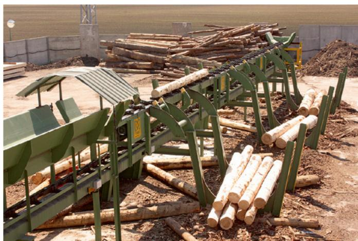
Das bis zu 5 m lange Rundholz wird in fünf Boxen plus eine Überrollbox eingeteilt
