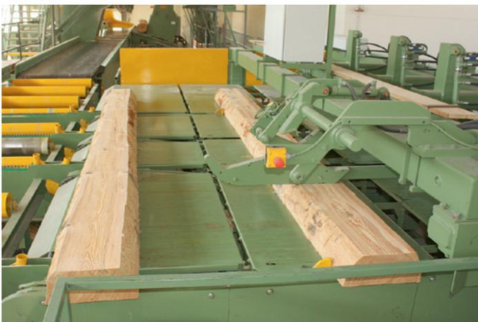
**Einzugstisch vor dem Combimes:** Laservermessung von oben plus Optimierung bestimmt den Einschnitt
