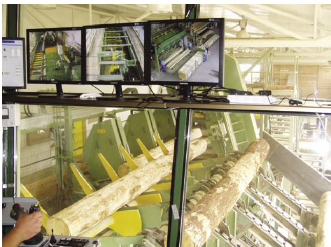
Kvalitu a rýchlosť porezu ovplyvňuje operátor pílnice
